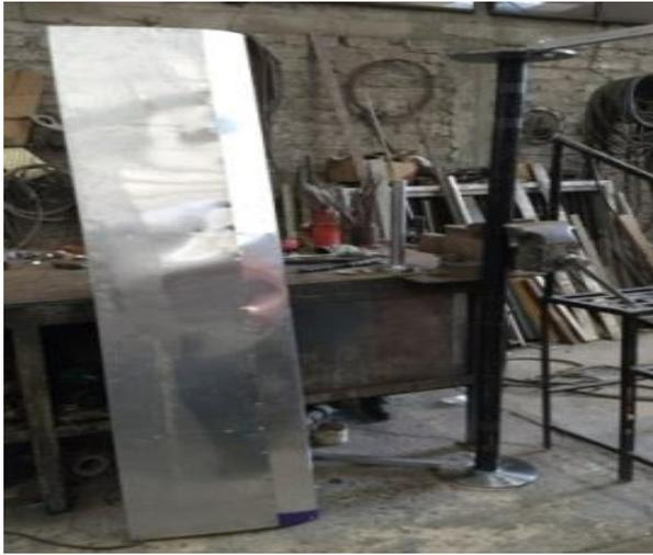
**Figura 6** Pala del rotor helicoidal
