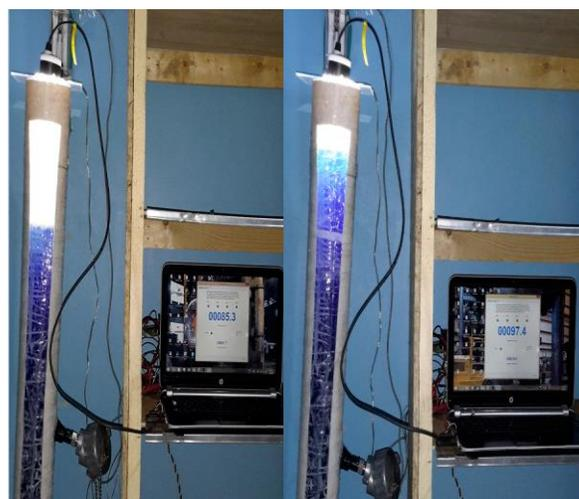
**Figura 15** Conexión de un sensor ultrasonico de nivel.
