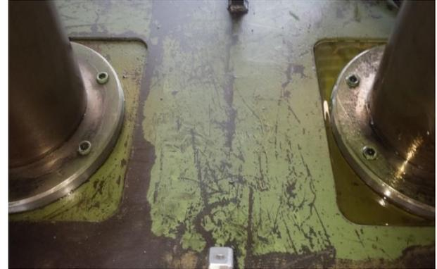
**Figura 5** Fuga de aceite de una prensa hidráulica
